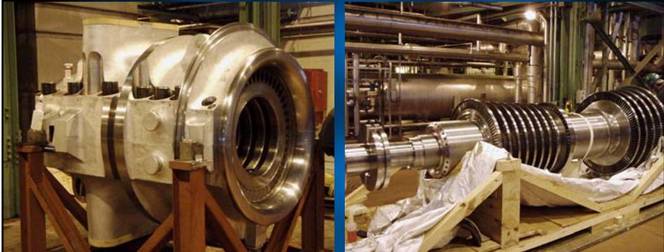
New HP-IP Inner Shell      New HP-IP Rotor
